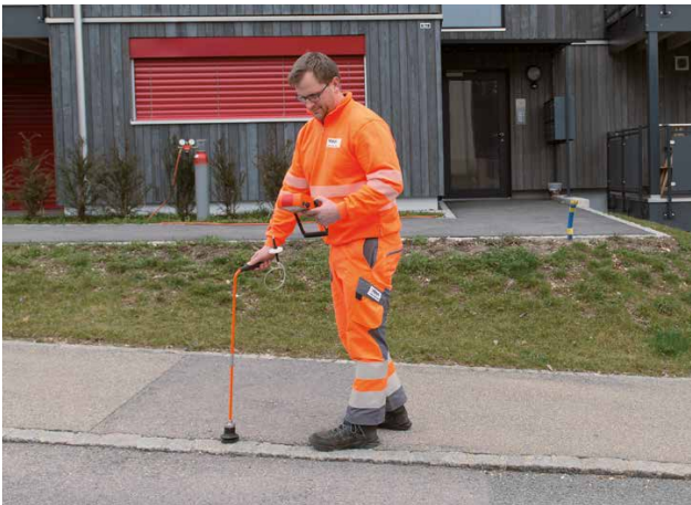
Dispositif de mesure avec gaz traceur Utilisé dans des conditions complexes ANr. 4374
