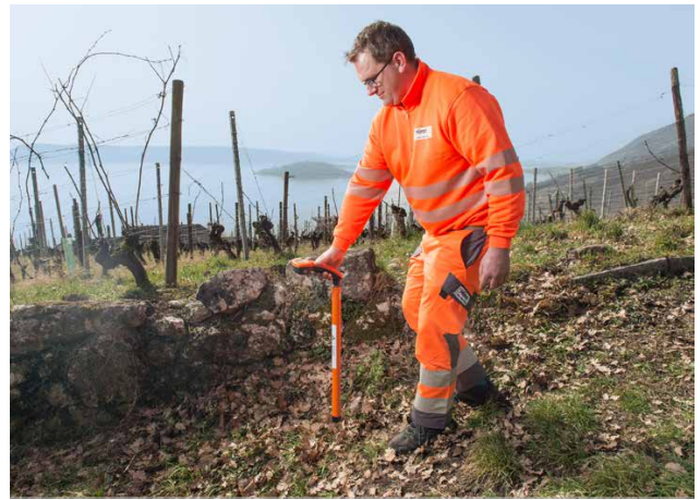
Recherche de vannes et de regards Localisation et marquage de l'emplacement des vannes et des regards ANr. 4380
