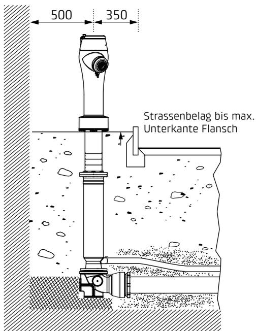
Entwässerung ins Erdreich mit Sickerpackung
