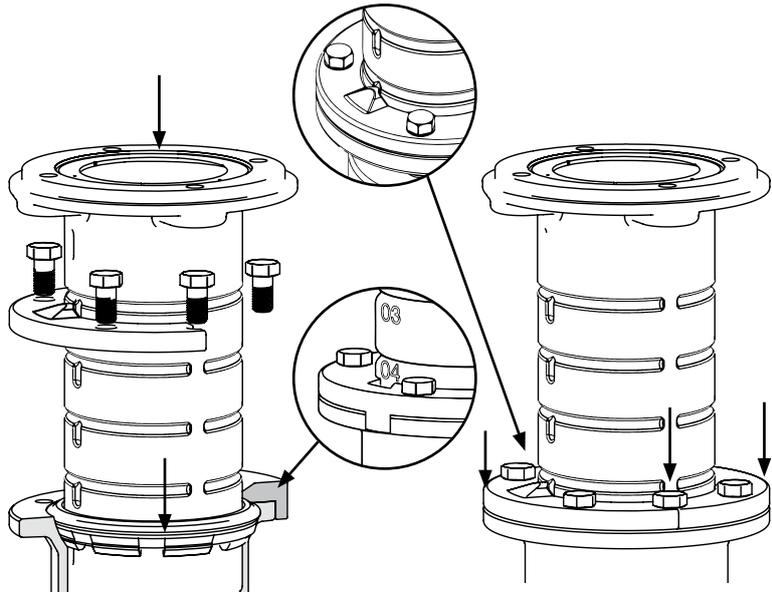
Steigrohr in den Steigrohrmantel einsetzen und Skala auf Nutausrichten
